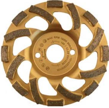
Plateau diamanté à segments virgules pour un surfaçage très rapide et de finition parfaite. Des trous de dimension optimale pour une meilleure évacuation des poussières. Version légère, longue durée de vie. Segments brasés.
