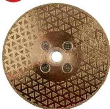
Disque à jante continue adapté pour la coupe et le chanfreinage. Une face entièrement diamantée par dépose électrolytique. Diamants de haute qualité optimisés pour tous types de matériaux.
