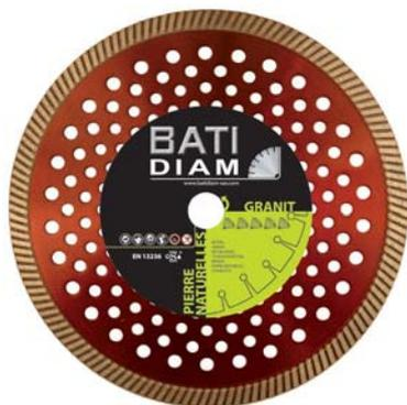
Disque très apprécié par son confort acoustique grâce à sa tôle ultra perforée. Une jante continue rainurée réduit le friction et assure un meilleur refroidissement. La flasque centrale pour les  $\varnothing$  125 et 230 mm procure une meilleure rigidité, et un confort pour des coupes précises.
